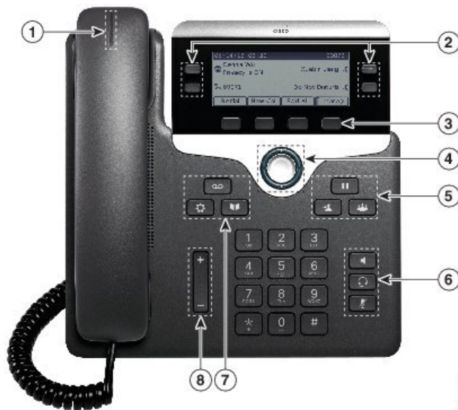
Illustration 1 : Touches et fonctionnalités des téléphones Cisco IP Phone 7800 Series
