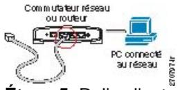
**Étape 5** Reliez l'autre extrémité du câble réseau au port Ethernet de la caméra Cisco WVC210.
