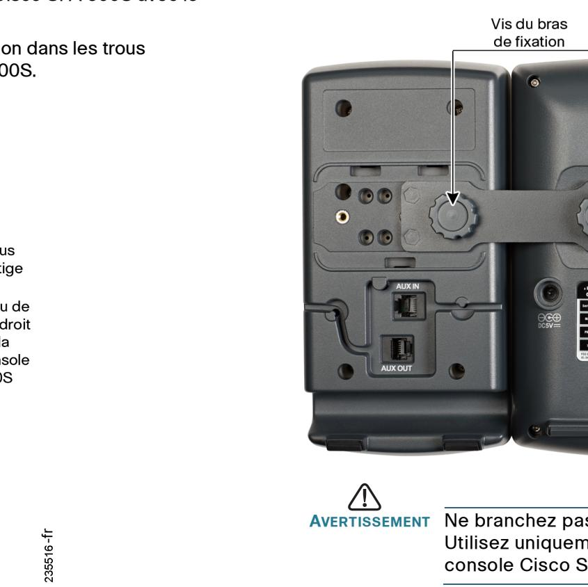
**ÉTAPE 7** Fixez le bras de fixation à la console Cisco SPA 500S à l'aide de la vis du bras de fixation.
