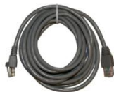
Un câble Ethernet (CAT5/RJ-45)
