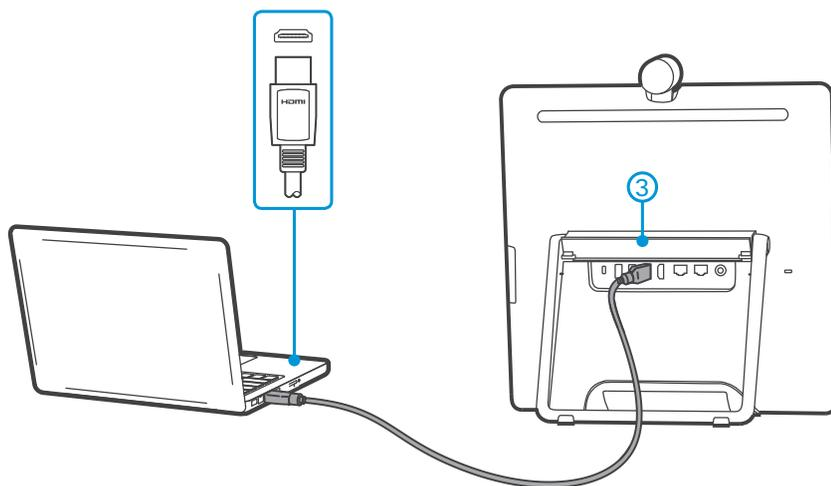
Le DX70 peut être connecté à un moniteur externe en utilisant la sortie HDMI.
