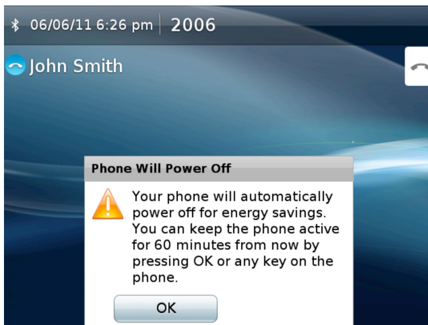
図 1 電話機に表示される Power Save + アラート
